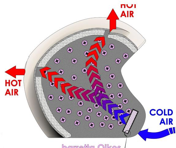
Schema di funzionamento del sistema su casco da sci
