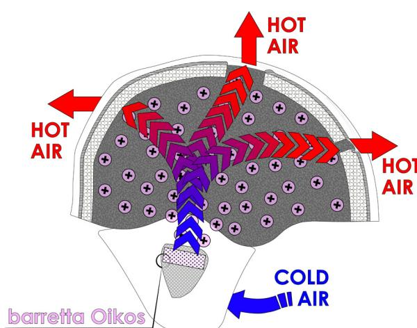
Schema di funzionamento del sistema su casco da snowboard
